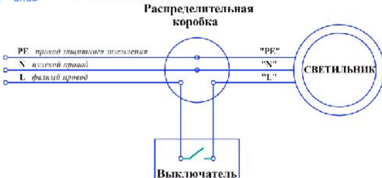
Рисунок 1. Схема подключения светильника к электросети 220В.
